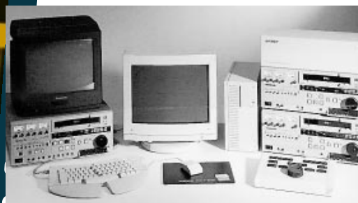
So sieht eine komfortable Videostudio-Steuerung aus: Ein oder zwei Zuspielder, ein Recorder und ein TV-Monitor. Dazu ein Macintosh der gehobeneren Klasse mit der Videomachine-Karte, einem 16-Zoll-Monitor sowie Grafik- und Animationssoftware nach Ihrem eigenen Geschmack.
