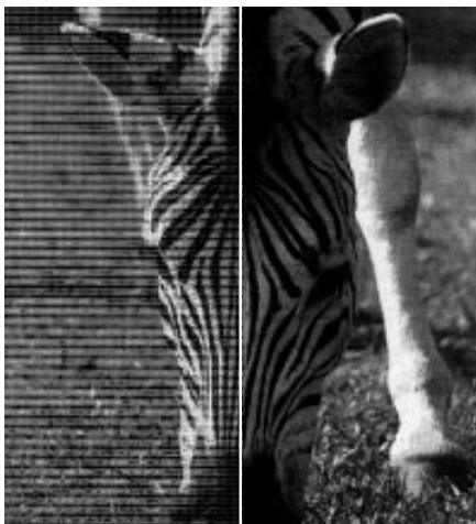
Graustufenausdruck 200-fach vergrössert. Links mit 300, rechts mit 1200 dpi.
