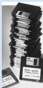
Die neue LS-120-Diskette speichert 83-mal mehr Daten als herkömmliche 1.44-MB-Disketten!
