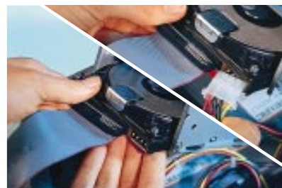
Ohne Gewalt lassen sich Datenkabel (unten) und Stromkabel (oben) anschliessen.
