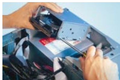
Die Platte wird – ggf. mit Führungsschienen – in den Laufwerk-Einschub geschraubt.
