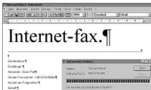
Das direkte Faxen formatierter Seiten ist über einen virtuellen Faxtreiber direkt aus Word möglich, hier FaxSav.
