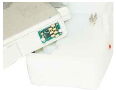
Beim Epson funktioniert die nachgefüllte Patrone nur, wenn der Chip ausgetrickst wird.
