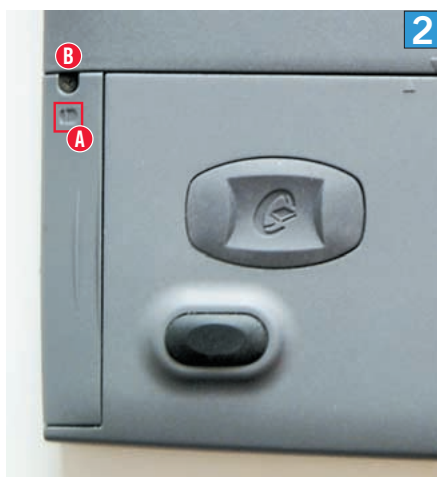
Am Festplattensymbol A zu erkennen: Hier steckt die Festplatte wie eine Schublade drin, die mit einer Schraube B befestigt ist
