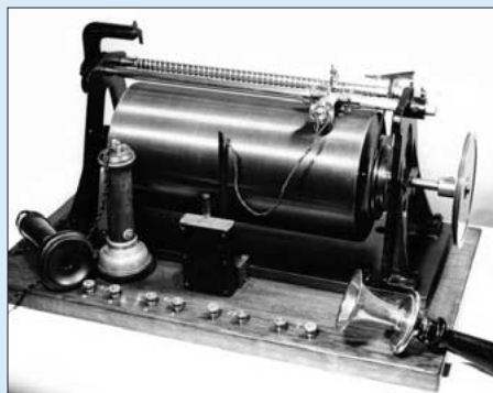
Das Poulsen Telegraph war die erste Festplatte und diente als Anrufbeantworter
