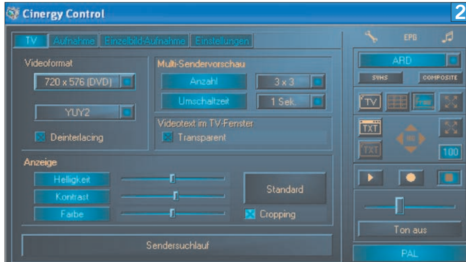
Die TV-Software der Cinergy 600 TV lässt nur eine maximale Auflösung von 720 x 576 Pixeln zu. Immerhin liegt der Karte zusätzlich die Abspiel-Software WinDVR bei, die eine Vollbildwiedergabe unterstützt
