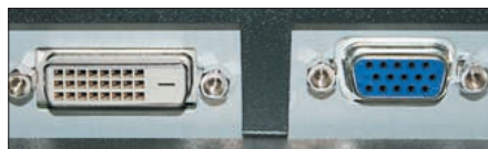
Links der digitale, rechts der analoge Ausgang am Bildschirm
